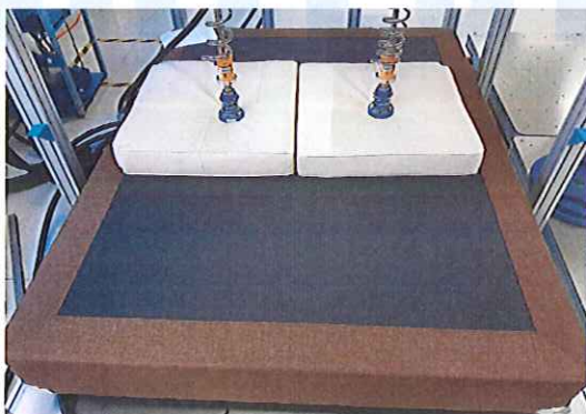
Thử tải tĩnh thẳng đứng mép giường/ Vertical static load test of the edge of the bed
