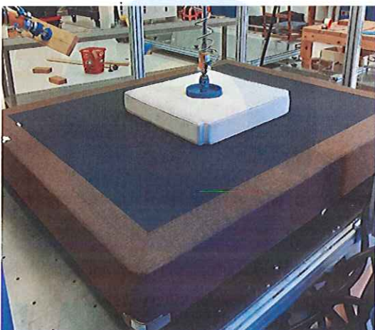
Thử tải tĩnh thẳng đứng/ Vertical static load test
